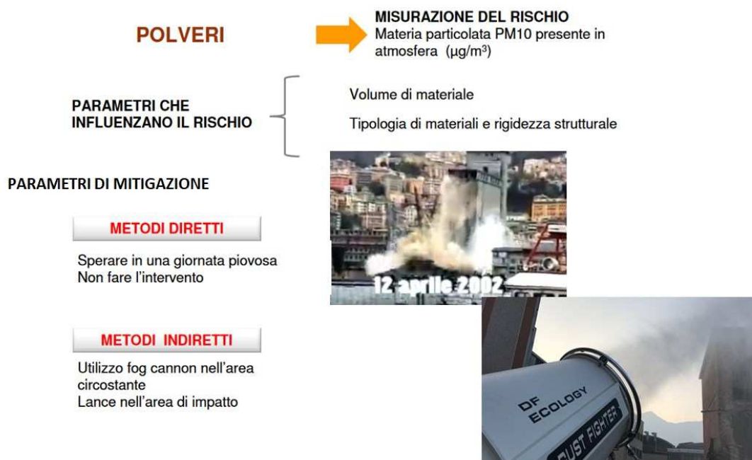
Getto d'acqua nebulizzata mediante cannon fog
